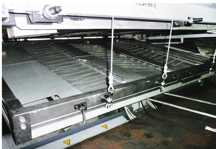
Сурет 3.7 – Инфракрасное сушильное устройство рулонной печатной машины
